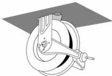
Installation au plafond
